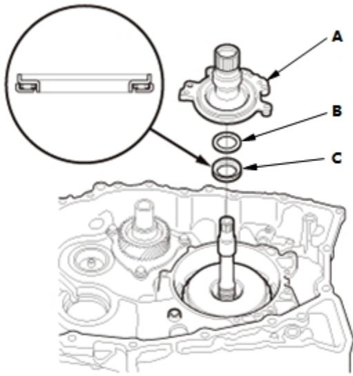
3. 通过将导向孔 (C) 与导向凸舌(B) 对齐来安装变速箱油润滑管 (A)。
