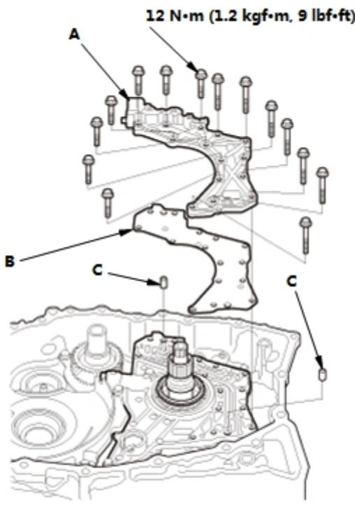
6. 安装变矩器壳体 (A) 及定位点 (B)，并分两步以交叉方式紧固螺栓。
